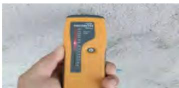
基层PH值(碱性)应在10以下。而且基层碱性的强弱同基层含水率也密切相关。所以需密切关注基层含水率,过高会导致泛碱问题(可使用PH试纸测试)。
